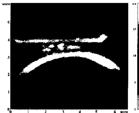
Рис. 3.17. Изображение рельефа квазиодномерного канала, полученного окислением танталового «крестика»
