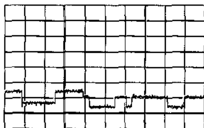
Рис. 3.9. Осциллограмма спонтанного переключения напряжений на полимерном микропроводнике при T = 299,2 К
